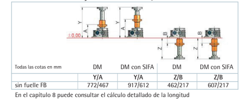
Alturas de montaje con carrera 0 y husillo Tr 140x20
